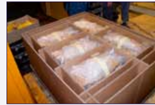
Exportverpackung für Zylinderköpfe (Palette, Karton, Zwischenlagen, Gefache, Beutel, BRANOROST, Flachpolster)
